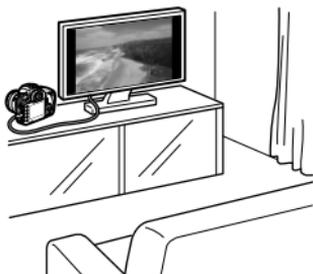
Utilize o cabo AV fornecido ou um Cabo HDMI HTC-100 (vendido em separado) para ligar a câmara a um televisor. Depois, pode reproduzir os filmes e as fotografias captados no televisor. Se tiver um televisor de Alta Definição e ligar a câmara ao mesmo utilizando um cabo HDMI, pode ver filmes em Alta Definição Total (Full HD: 1920 x 1080) e em Alta Definição (HD: 1280 x 720) com uma imagem de qualidade superior.
