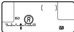
Se a velocidade ISO estiver definida para “A” (Auto), a velocidade ISO real a definir aparece quando carrega no botão do obturador até meio. Conforme se indica abaixo, a velocidade ISO é definida automaticamente em função do modo de disparo.
