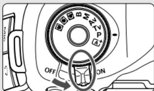
**Coloque o interruptor de alimentação na posição <ON>** (p.34).
