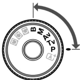
Nos modos de disparo **P/Tv/Av/M/B**, pode seleccionar a velocidade do obturador, a abertura e outras definições da câmara para alterar a exposição e obter o resultado pretendido.
