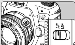
**Coloque o interruptor de modo da focagem da objectiva na posição <AF>** (p.39).
