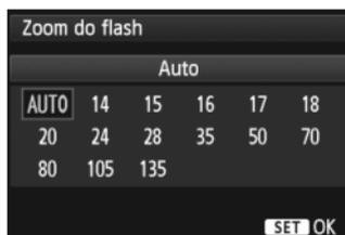
Se utilizar Speedlites com uma cabeça de flash zoom, pode definir a cobertura de flash. Normalmente, defina esta opção para **[AUTO]** de forma a que a câmara especifique automaticamente a cobertura de flash de acordo com a distância focal da objectiva.
