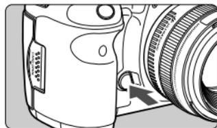
Carregue no botão de pré-visualização de profundidade de campo para reduzir a objectiva para a definição de abertura actual e verifique a profundidade de campo (intervalo de focagem aceitável).
