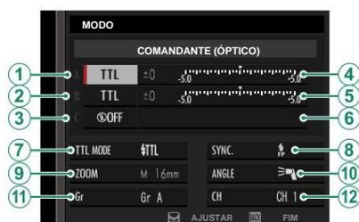
O controle remoto de flash óptico sem fio Fujifilm oferece uma escolha de quatro canais (canais 1 a 4) para a troca de sinais ópticos entre o comandante e as unidades de flash remotas. Canais separados podem ser usados para diferentes sistemas de flash ou para evitar interferência quando vários sistemas estão operando em estreita proximidade.
